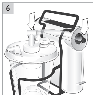
6 Kontrollér, at alle tilslutninger til vakuumslangen er fastgjort ordentligt.
