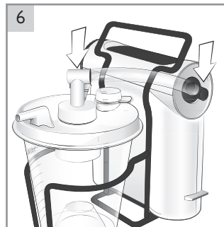
6 Sprawdzić solidność mocowania wszystkich złączy rurki podciśnieniowej.
